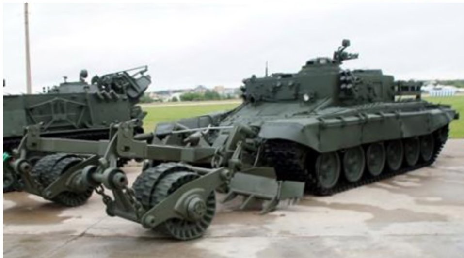
Рисунок 5 – Бронированная машина разминирования БМР-3М «Вебрь»
