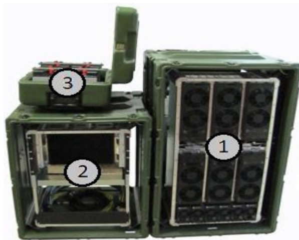
Рисунок 6 – Комплект мобильной базовой станции
