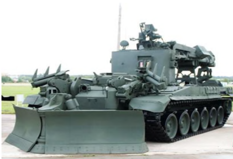
Рисунок 4 – Инженерная машина разграждения ИМП-3М
