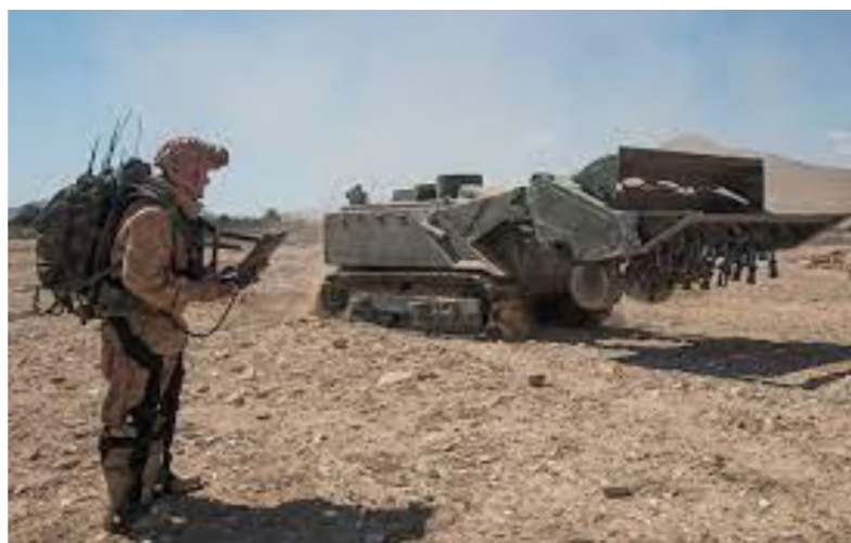
Рисунок 1 – Многофункциональный робототехнический комплекс разминирования Уран-6
